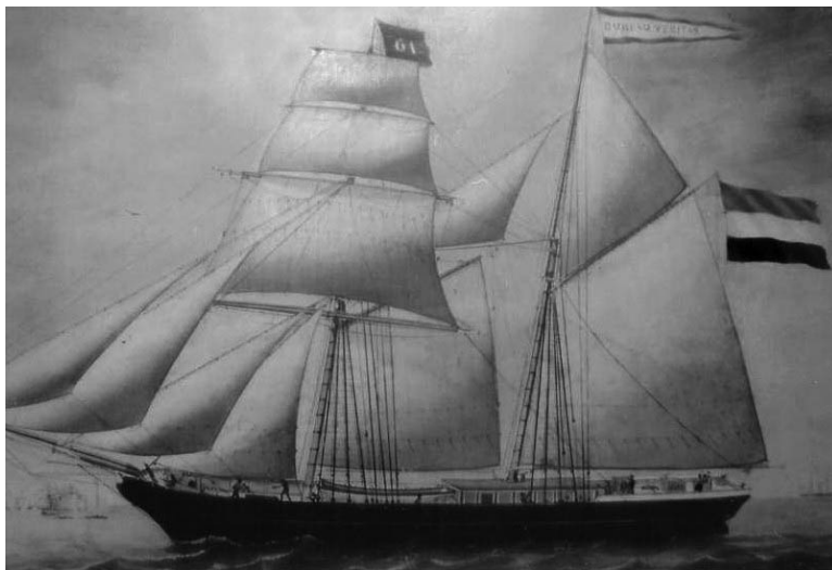
Twee-mast schoener Bureau Veritas, 25,4 m lang en 4,08 m breed, 150 ton (bron Piet's scheepsindex)
